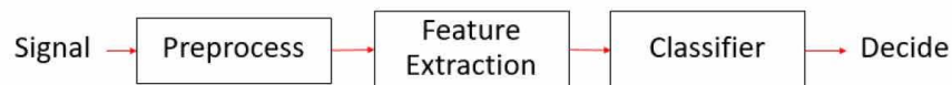
ภาพที่ 7 แสดงบล็อกไดอะแกรมของระบบการจำแนกเสียง
